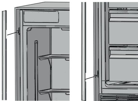
Encaixe a peça superior do acabamento no suporte de conexão superior
