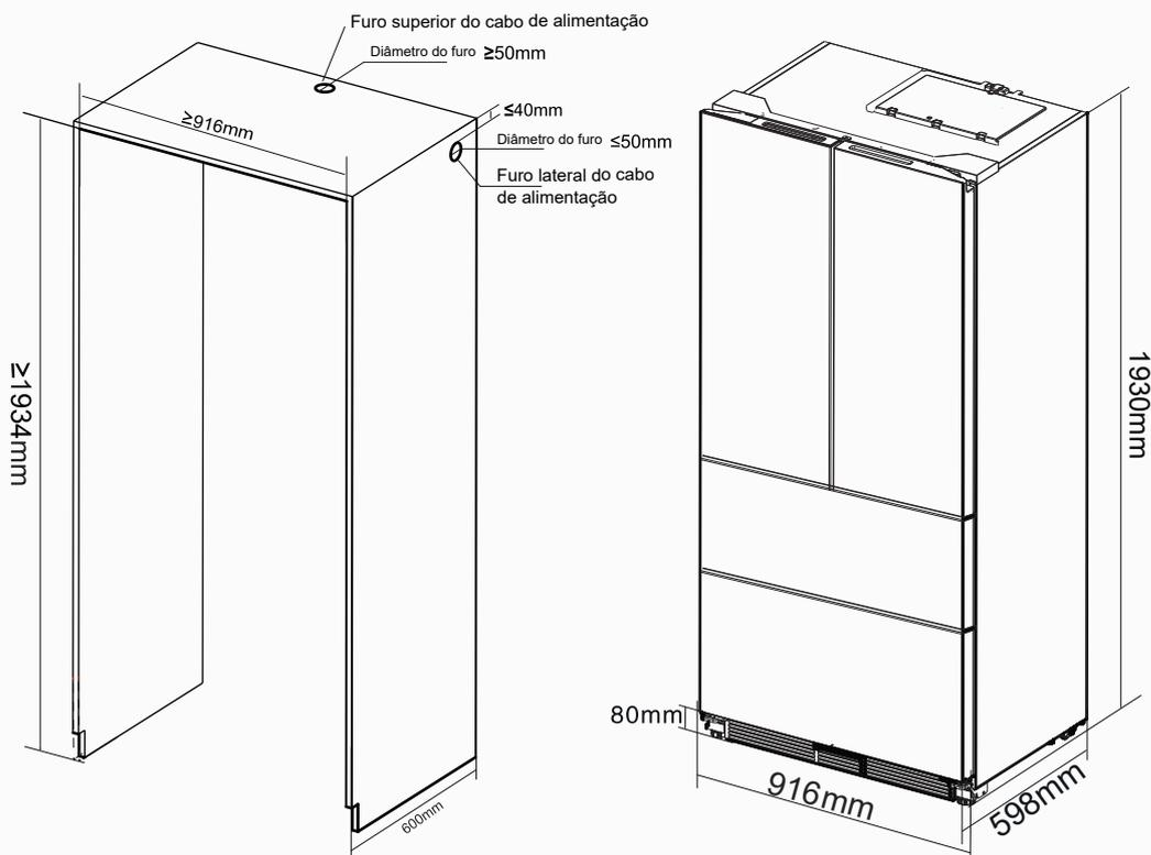
As figuras acima são uma diretriz para fins de instalação. As dimensões reais do refrigerador podem variar ligeiramente. Para garantir que seu refrigerador funcione com eficiência máxima, mantenha espaço suficiente ao redor de sua unidade, conforme descrito acima.
