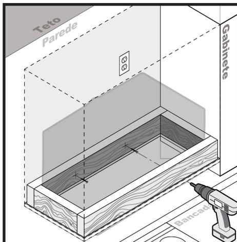
Através dos orifícios de instalação, fixe a coifa na estrutura de reforço, utilizando os parafusos "A"
