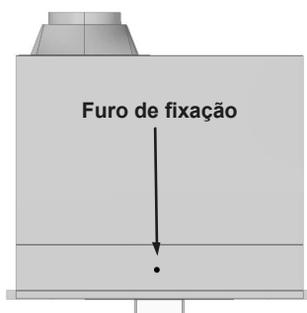
Furos de montagem pré-perfurados são fornecidos em cada lado do corpo da coifa. Caso ache necessidade de uma fixação mais reforçada, poderão ser feitos novos furos no corpo da coifa.
