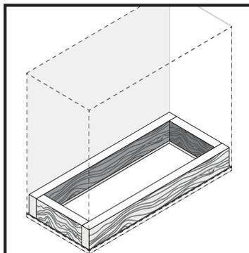
Instale uma estrutura interna de madeira, essa estrutura será utilizada para fixar os parafusos de fixação da coifa. Essa estrutura deverá ter 10cm de altura e uma espessura mínima de 1,5cm.
