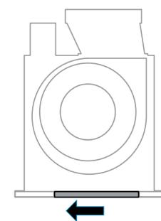
Apoiando o filtro direcione-o para a parte frontal, finalizando a instalação
