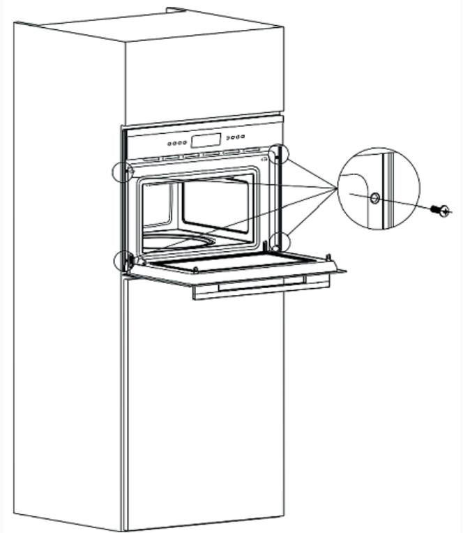
O micro-ondas possui 4 parafusos na parte interna da moldura de instalação.
