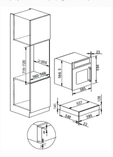
O posicionamento das canaletas deve ser como na imagem a seguir, nas paredes do nicho, para encaixar a gaveta no adesivo (caso seu nicho não possua parede de fundo, não existe a necessidade da instalação da canaleta no fundo).
