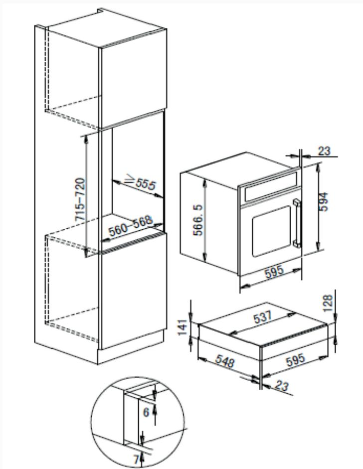
O posicionamento das canaletas deve ser como na imagem a seguir, nas paredes do nicho, para encaixar a gaveta no adesivo (caso seu nicho não possua parede de fundo, não existe a necessidade da instalação da canaleta no fundo).
